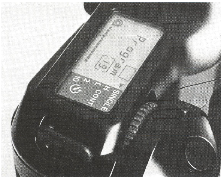
På kameraets overside sidder et stort LCD-display bestående af i alt 223 »byggeklodser«. Display'et giver kun de informationer, fotografen har brug for i den aktuelle situation.
