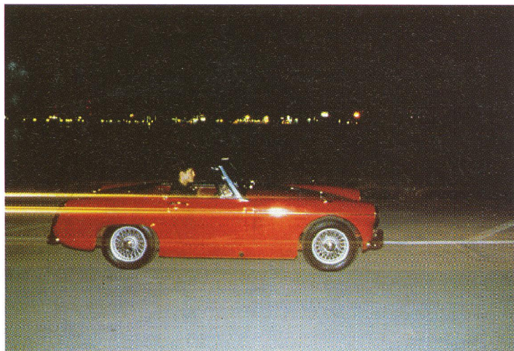
»Second Curtain Flash Photography« betyder, at flashen først udløses et mikrosekund før andet lukkergardin frigives. Derved opnår man ved fotografering på tid, at bilens lygter trækker striber bagud i stedet for forud som ved normal flashfotografering. Hvad man ellers skal bruge denne enstående facilitet til, er svært at sige.
